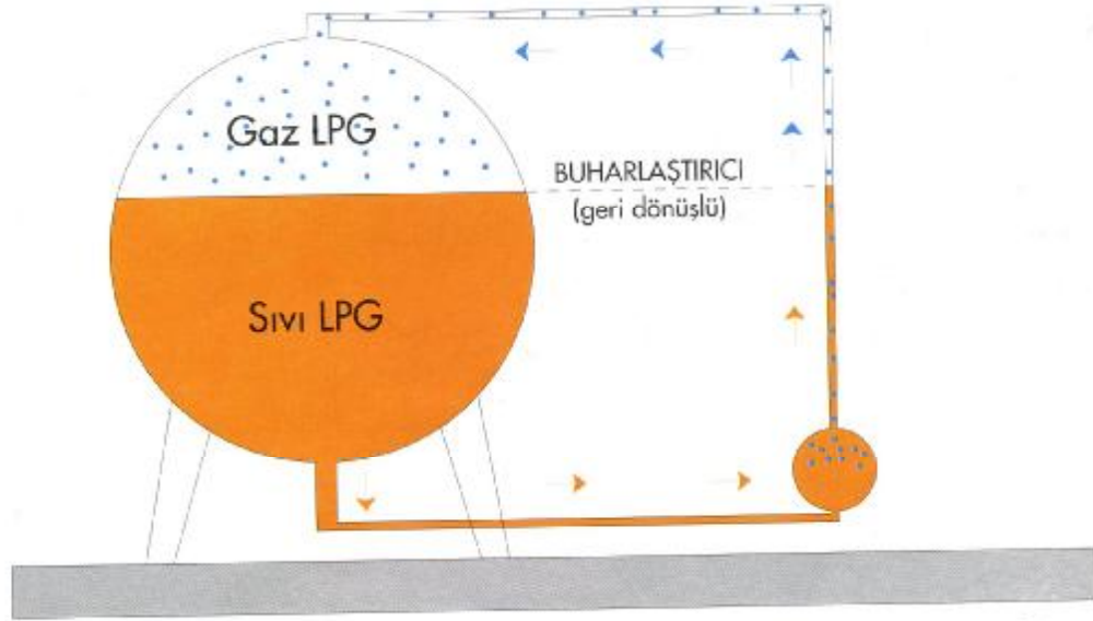
Şekil 3: Küçük Tanklı Dökmegaz Sistemi'nin Çalışma Prensibi
